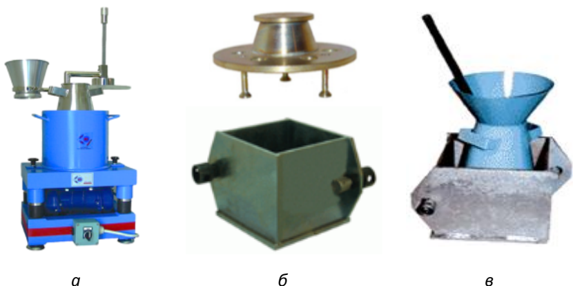
Рис. 5. Приборы для определения жесткости бетонной смеси: а — прибор Вебе; б — прибор Красного; в — прибор Скрамтаева
