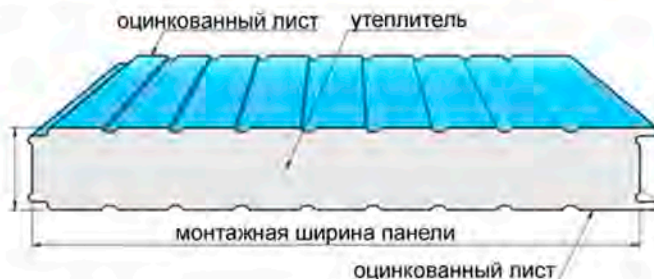
Рис. 2. Элемент стенового заполнения.
