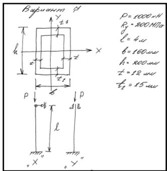
Требуется с учетом граничных условий определить приведенную длину колонны. Определить геометрические характеристики сечения (площадь, моменты и радиусы инерции относительно главных центральных осей). Определить гибкость колонны в двух плоскостях и для заданной стали коэффициенты продольного изгиба.
