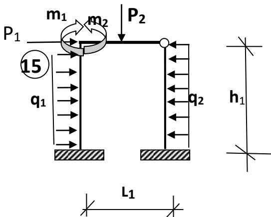
Для рамы заданной конфигурации, при заданных: размерах поперечного сечения элементов рамы, характеристиках материала, внешних нагрузках показать ход расчета методом конечных элементов. Отразить следующие этапы расчета:
