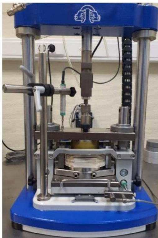
Рисунок 1.29. Прибор простого сдвига, производства ООО «НПП Геотек»
