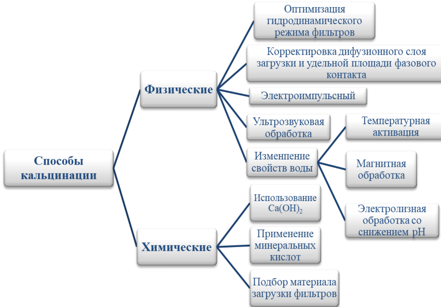
Рисунок 3.5 – Классификация способов интенсификации процесса фильтрационной и реагентной кальцинации мягкой воды
