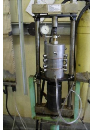
Рисунок 1 - Приборы для определения коэффициента фильтрации образцов: а) прибор дивергентной осе-симметричной фильтрации; б) фильтрационно-компрессионный прибор конструкции ВНИИГ
