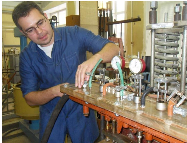
Рисунок 2 - Испытания образцов на эрозионную устойчивость в суффозионном щелевом лотке
