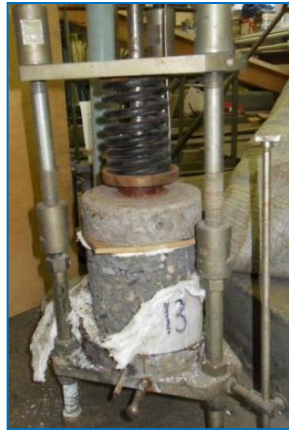
Рисунок 1 - Приборы для определения коэффициента фильтрации образцов: а) прибор дивергентной осе-симметричной фильтрации; б) фильтрационно-компрессионный прибор конструкции ВНИИГ
