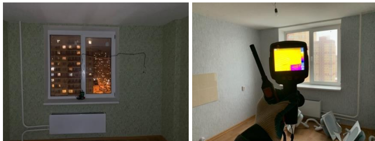
Рисунок 5. Определение границ термически однородных зон и установка датчиков измерителя плотности тепловых потоков
