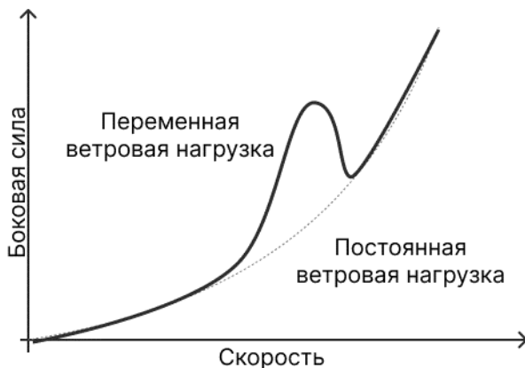
Рисунок 2. Зависимость боковой силы от скорости ветра
