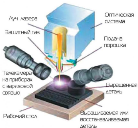
Рисунок 1. Общая схема рабочей зоны 3D-принтера, работающего по технологии DMT
