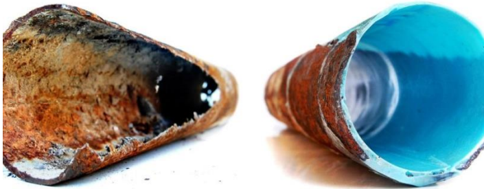
Рисунок 1. Результат восстановления трубопровода по технологии Swagelining
