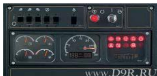
Рисунок 1. Приборная панель бульдозера Cat D9R с системой контроля
