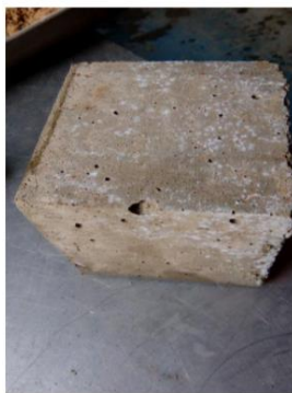
Рисунок 1. Изменение состояния бетона за 2 года: а) не модифицированного гидрозолем; б) модифицированного гидрозолем.
