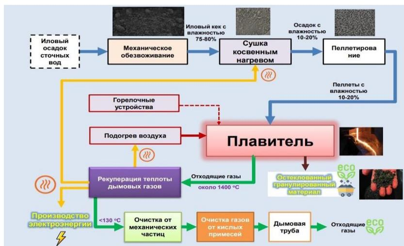
Рисунок 1. Технологическая схема остеклования илового осадка
