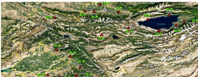
**Рисунок 6.** Космоснимок пунктов сети сильных движений для системы раннего оповещения населения от разрушительных землетрясений на территориях городов Бишкек и Ош
