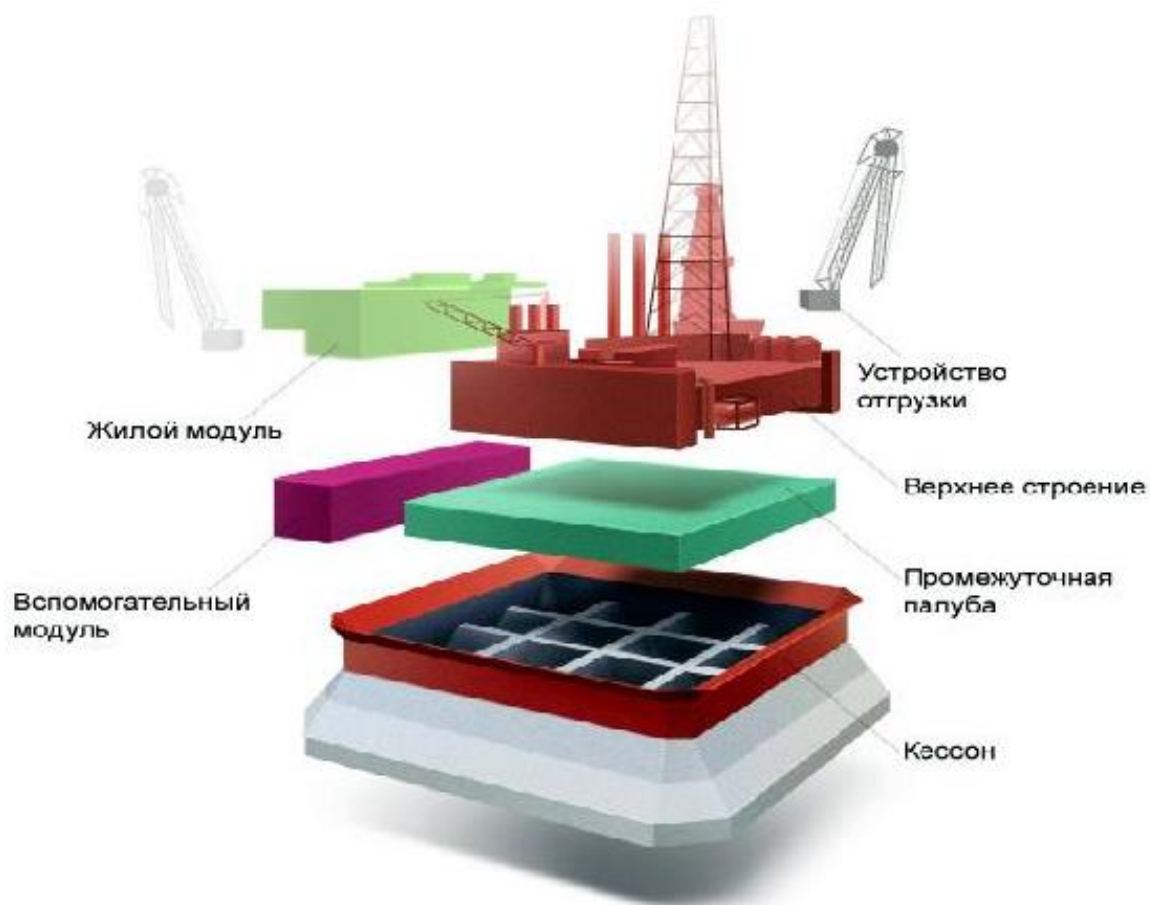
Рисунок 3 – Строение платформы «Приразломная»
