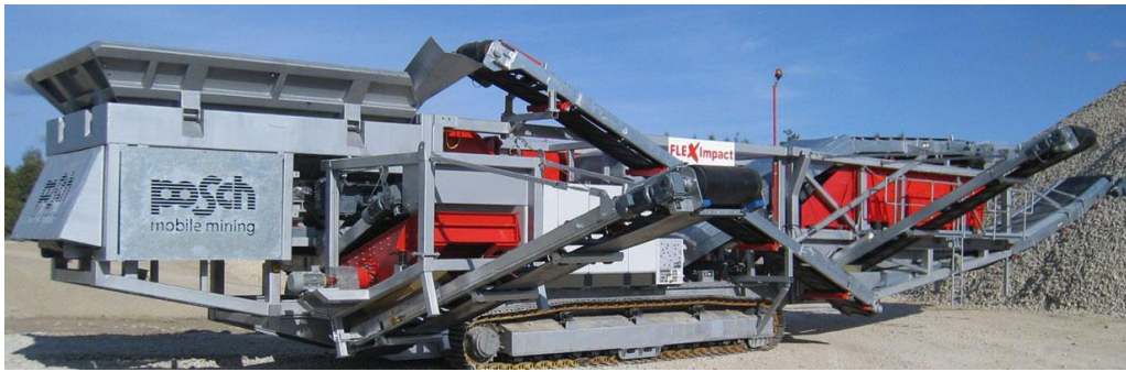
Рисунок 3. Установка УМДС 250 (Союзгормаш), способная перерабатывать бетонные отходы, содержащие арматуру диаметром до 50 мм [11]
