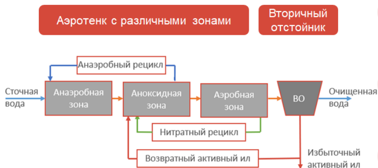
Рис. 7. Схема процесса UCT
