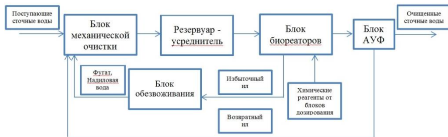
Рис. 1. Принципиальная схема технологического процесса очистки хозяйственно-бытовых сточных вод
