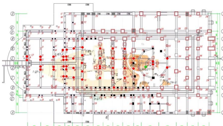
Рисунок 14. План фундаментов с нанесенными сваями и скважинами.
