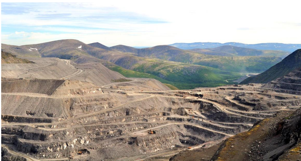
Рисунок 3. Центральный рудник. Седловина между Северным (слева) и Южным (справа) Расвумчорром, преобразованная крупным нагорным карьером. На среднем плане в северной стенке карьера заметны техногенные обнажения рихсчорритов висячего блока. Часть отвалов пустой породы складирована на северном Расвумчорре. [Фото М. Иванова]
