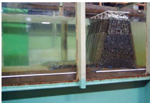
Рисунок 5. Проведение испытаний моделей мола в гидроволновом лотке
