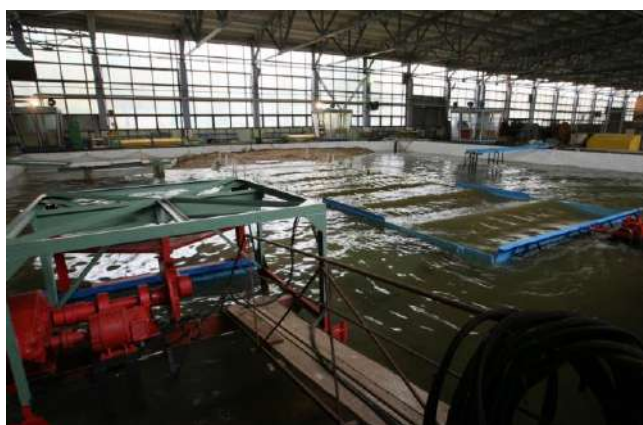
Рисунок 6. Внешний вид бассейна с волнопродуктором типа качающегося щита
