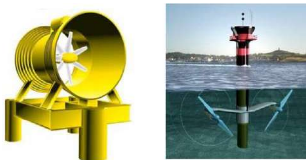
Рисунок 8. Преобразователи энергии приливного потока: а) RTT2000 б) SeaGenS
