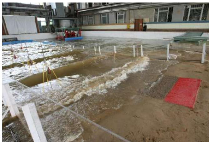
Рисунок 7. Проведение испытаний в бассейне с волнопродуктором
