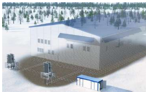
Рисунок 2. Пример применения горизонтальной термостабилизации
