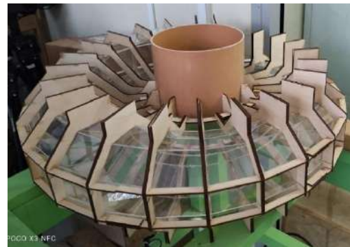
Рисунок 4. Модель спиральной камеры вид сбоку.
