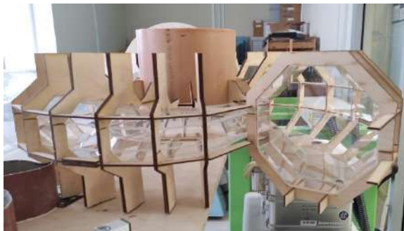
Рисунок 3. Модель спиральной камеры вид сверху.
