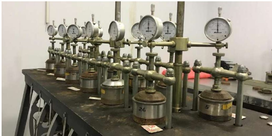
Рисунок 1. Компрессионный многокамерный прибор для испытания мерзлых грунтов при оттаивании в лабораторных условиях. Прибор размещен в специальной камере в условиях контролируемой температуры в спектре от положительных до отрицательных температур.
