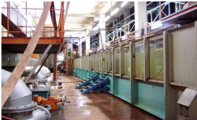
Рисунок 4. Внешний вид гидроволнового лотка
