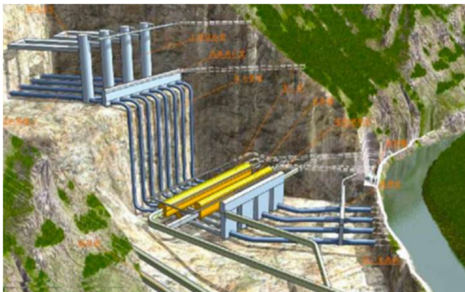
Рисунок 5. Подземная гидроэлектростанция Jinping-II (КНР)
