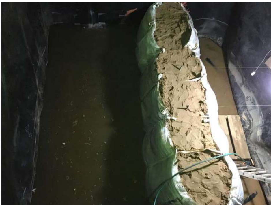
Рисунок 7. Конструкция дамбы, состоящая из 3-х ДПК
