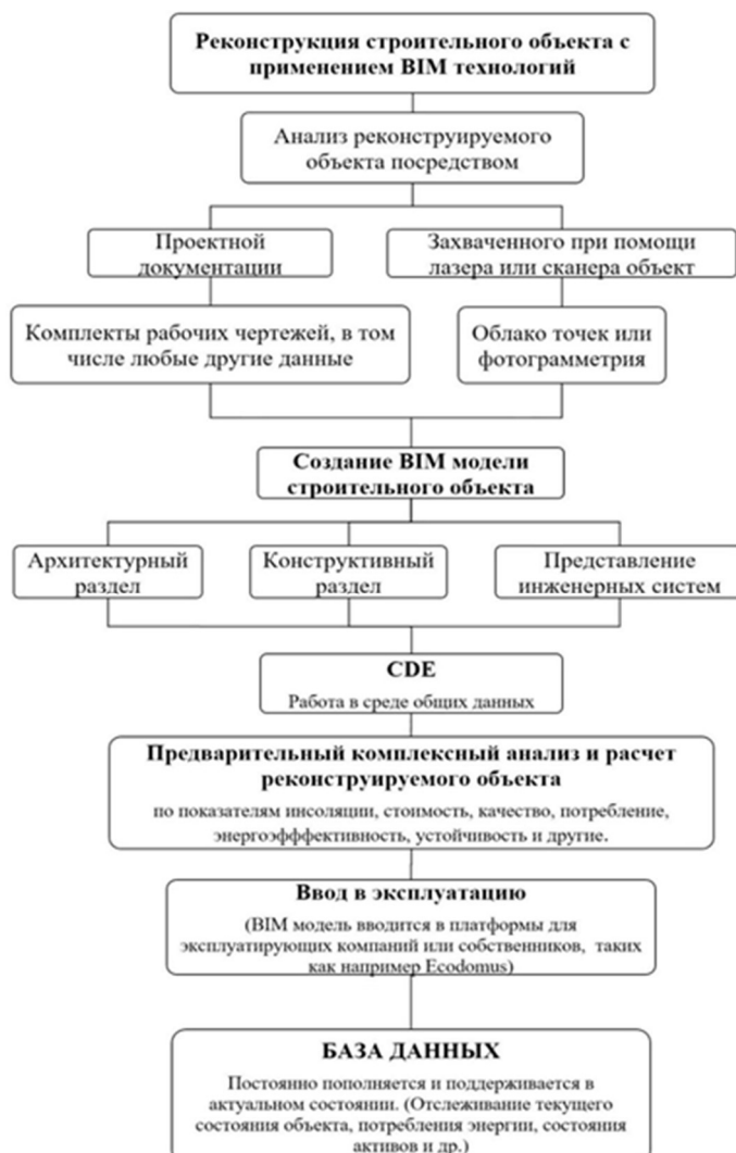
Рис. 1. Процесс реконструкции строительного объекта с применением BIM технологий
