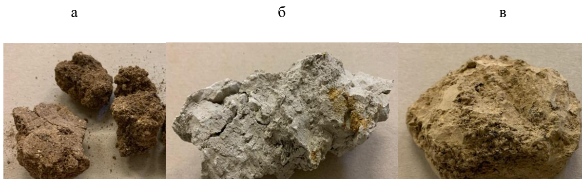
Рис. 2. Образец: а) красной глины Тюльганского месторождения; б) белой глины Тюльганского месторождения; в) глины Халиловского месторождения
