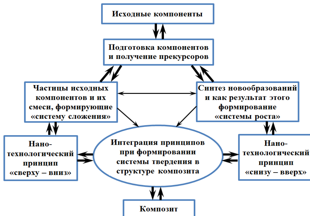
Рис. 1. Общая схема формирования структуры строительных композитов с позиций нанотехнологического подхода [1]
