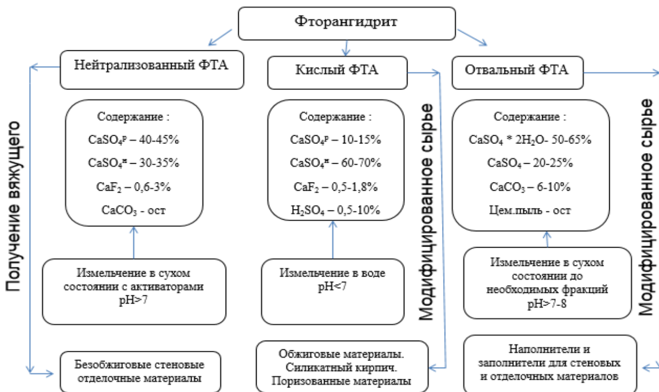
Рис. 1. Классификация фторангидрита по вещественному составу и применению
