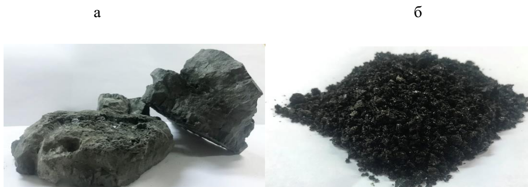
Рис. 1. Образец: а) медьсодержащего шлака Медногорского медно-серного комбината; б) никелевого шлака комбината «Южуралникель»
