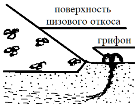
Рис. 3. Вероятный сосредоточенный очаг фильтрации в основании низового откоса Сардобинской дамбы, как начальная стадия развития подземной эрозии [3].
