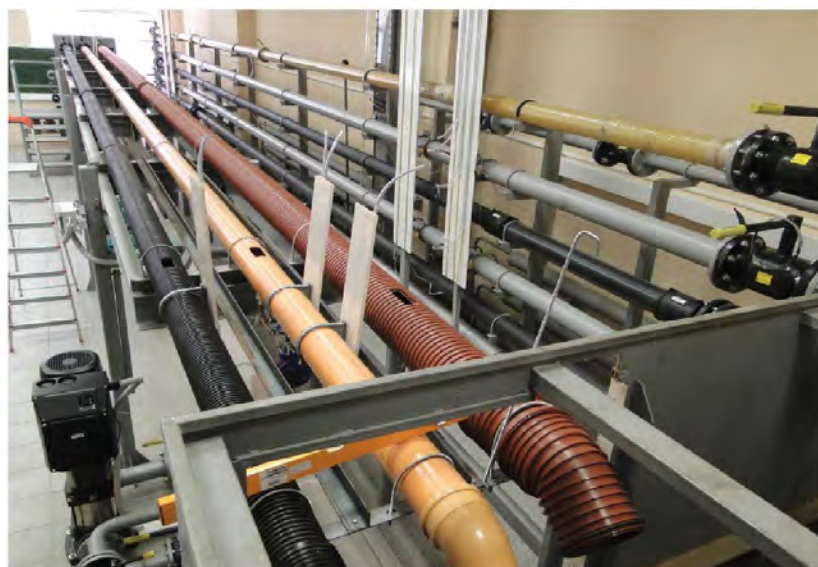
Рис. 1. Общий вид гидравлического стенда с исследуемыми трубами в лаборатории кафедры водоснабжения и водоотведения НИУ МГСУ
