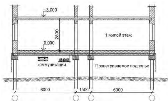
Рис. 1. Здания с вентиляруемым подпольем без технического этажа
