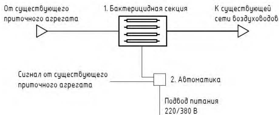
Рис. 2. Принципиальная схема встраиваемой секции обеззараживания воздуха в существующую систему вентиляции (кондиционирования)
