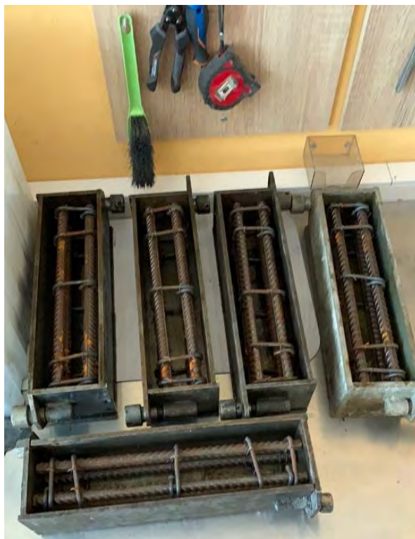
Рис.1. Фотографии образцов в формах перед бетонированием
