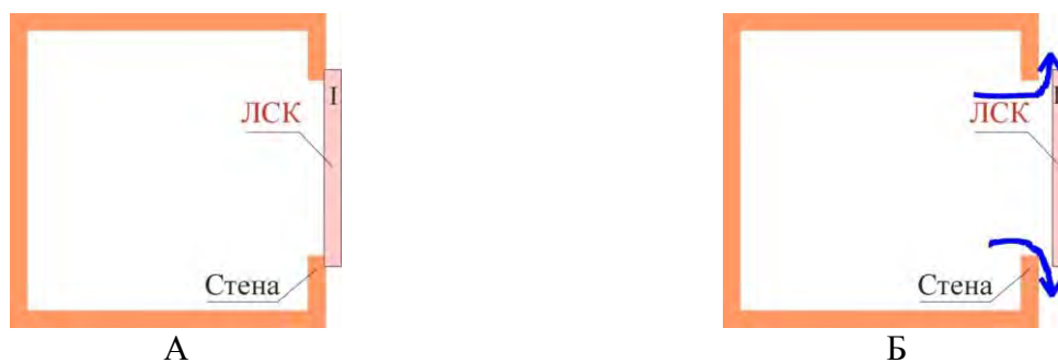
Рис. 1.1 Развитие аварии в помещении, оборудованном ЛСК, при первом типе ее крепления. А – общая схема крепления ЛСК; Б – срыв конструкции при внутреннем взрыве и начало сброса взрывного давления в атмосферу
