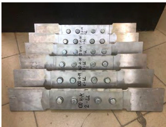
Фото 1. Серия образцов для статического растяжения. Поверхности трения обезжирены.
