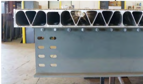
Рис. 4. Внешний вид плиты второго поколения, установленной на балке с дорожным покрытием
