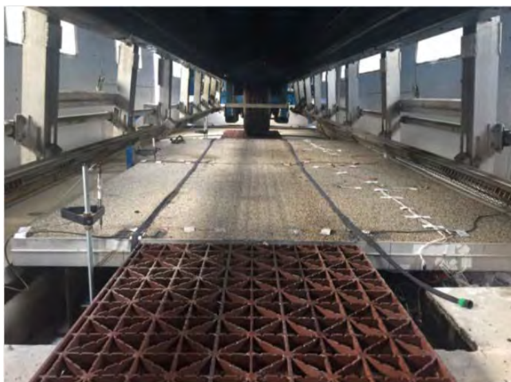
Рис. 5. Усталостные испытания плит и проверка истираемости дорожной одежды
