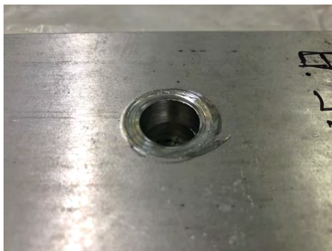
Фото 3. След от вмятия шайбы в алюминий при моменте затяжки 100 Н-м.
