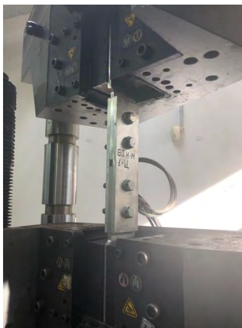
Фото 2. Образец в испытательной машине Instron 1000HDX.
