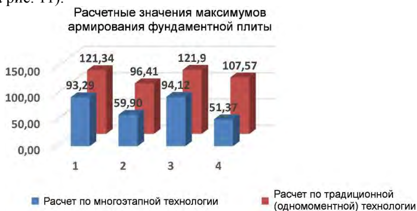
Рис. 11. Обобщенные результаты расчета максимальных значений требуемого армирования по двум вариантам расчетного анализа несущей системы (1 – нижнее армирование вдоль оси X; 2 – верхнее армирование вдоль оси X; 3 - нижнее армирование вдоль оси Y; 4 - верхнее армирование вдоль оси Y)
