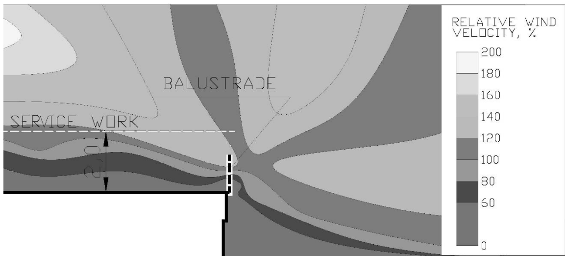
Рис. 1. Поле скоростей ветра в разрезе здания с балюстрадой на крыше.
