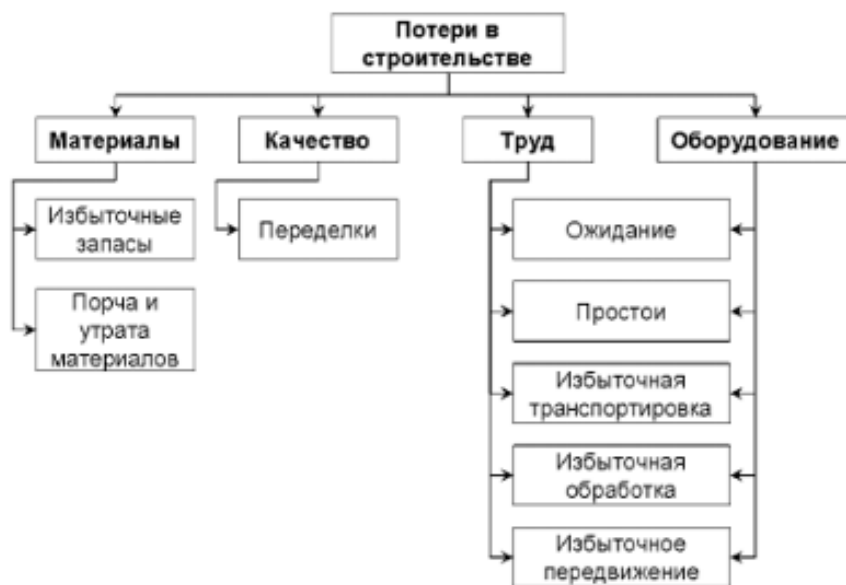
Рис. 1. Основные виды потерь в строительстве
