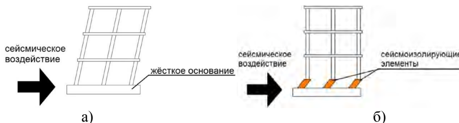
Рис. 1. а) деформированная схема неизолированного здания при сейсмическом воздействии; б) деформированная схема изолированного здания при сейсмическом воздействии
