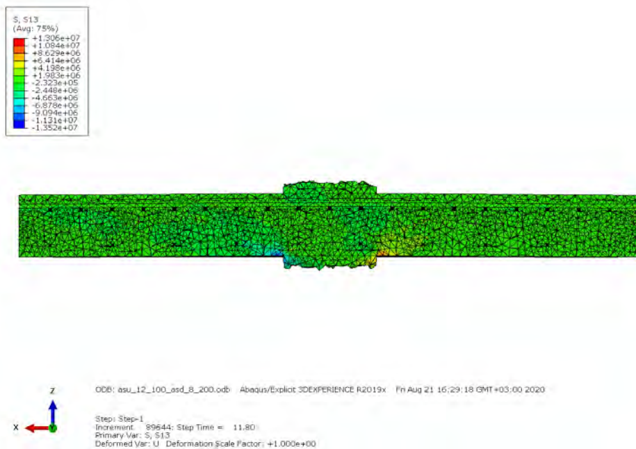
Рис. 5. Распределение сдвиговых напряжений в бетоне на этапе неупругой работы, Па
