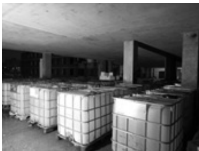
Рисунок 1. Общий вид загрузения плиты перекрытия
