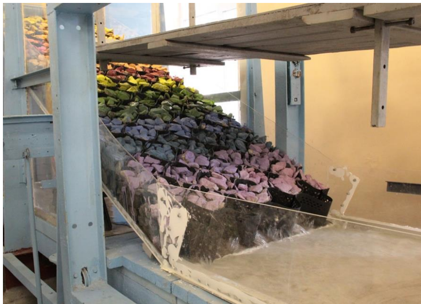
Рис. 2. Гидравлическая модель для определения эффективности удержания заполнителя-щебня при воздействии потока воды
