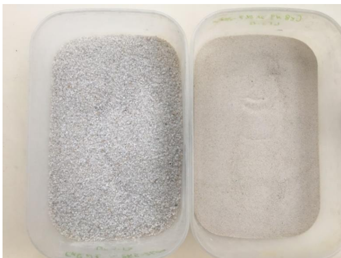
Рис. 2. Песок крупный (слева) и песок мелкий (справа)
