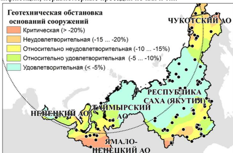
Рис. 3. Изменение расчетной несущей способности свайных фундаментов на примере висячей сваи 6 метровой длины по данным за 2000-2010 г.
