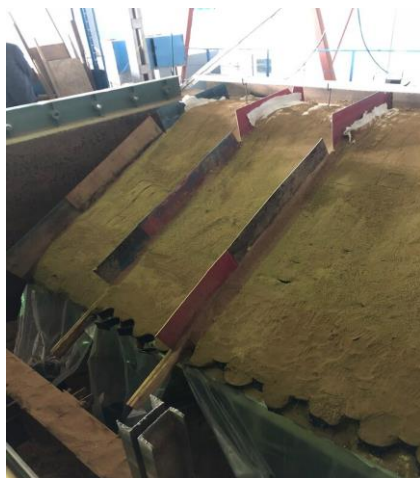
Рис. 3. Натурная модель откоса для определения эффективности удержания заполнителя-песка георешетками при воздействии потока воды
