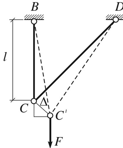
Очевидно, что усилие в стержне  $DC$  равно нулю, и, следовательно, точка  $C$  под действием приложенной вертикальной силы будет перемещаться перпендикулярно к направлению этого стержня.
