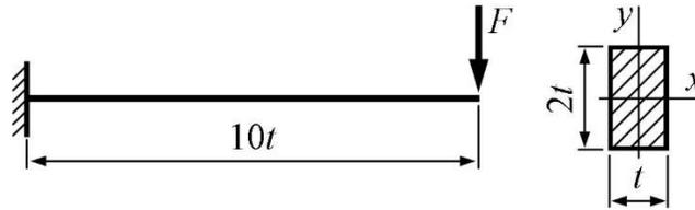
Консольная балка прямоугольного поперечного сечения нагружена силой  $F$ .
