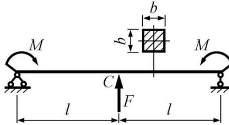
Шарнирно опертая балка квадратного поперечного сечения нагружена двумя сосредоточенными моментами  $M = 0,2$  кНм и силой  $F$ .
