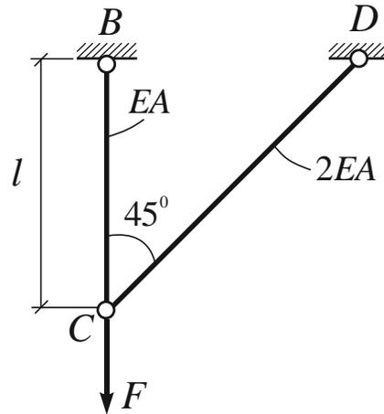
Стержневая система  $BCD$ , состоящая из двух стержней разной жесткости, загружена вертикальной силой  $F$ . Размеры и жесткости стержней показаны на чертеже. Здесь  $A$  – площадь поперечного сечения,  $E$  – модуль упругости материала.
