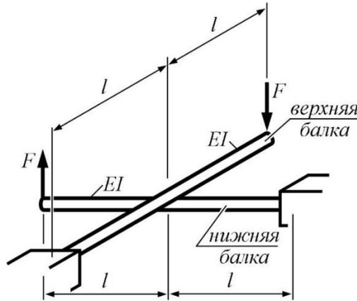
Система состоит из двух перекрестных балок круглого поперечного сечения и нагружена двумя силами  $F$ . Контакт между балками точечный. Жесткость поперечного сечения при изгибе  $EI$  известна.
