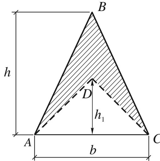
Из равнобедренного треугольника  $ABC$  с высотой  $h$  и основанием  $b$  вырезан равнобедренный треугольник с тем же основанием так, что его вершина  $D$  является центром тяжести оставшейся части фигуры.
