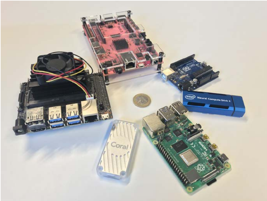
Рис. 15.1. Краевые устройства, где можно реализовать ИИ. Сверху и по часовой стрелке: PYNQ-Z2, Arduino UNO R3, Intel Movidius NCS2, Raspberry Pi 4, Google Coral USB Accelerator, NVIDIA Jetson Nano и в середине монета в 1 евро для масштаба
