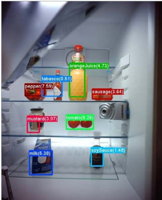
Рис. 14.21. Обнаруженные объекты и их классы в холодильнике SmartDeviceBox (изображение с сайта https://oreil.ly/xg0wT )
