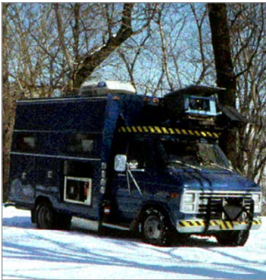
Рис. 1.5. Беспилотный автомобиль NavLab 1 1986 года во всей своей красе (изображение взято по адресу http://www.cs.cmu.edu/Groups/ahs/navlab_list.html )
