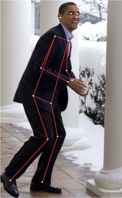
Рис. 10.11. Ключевые точки на фотографии президента США Барака Обамы, играющего в снежки, нарисованные моделью PoseNet
