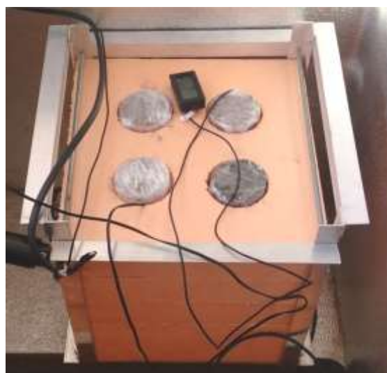
Рис. 1 Прибор для определения деформаций морозного пучения: а) схема прибора; б) прибор в морозильной камере
