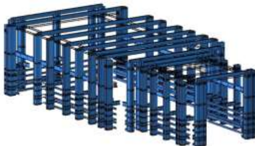
Рис. 3. Верхнее строение металлического каркаса ванной стекловаренной печи
