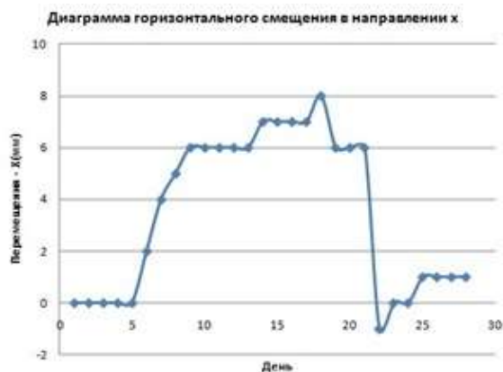
Рис. 5. График развития горизонтального перемещения верха шпунта в точке 17В
