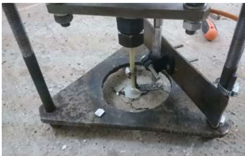
Рис. 3 Картина разрушения анкерного узла
