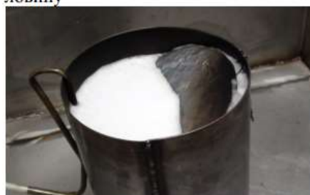
г) Пламя в обеих частях резервуара потушено
