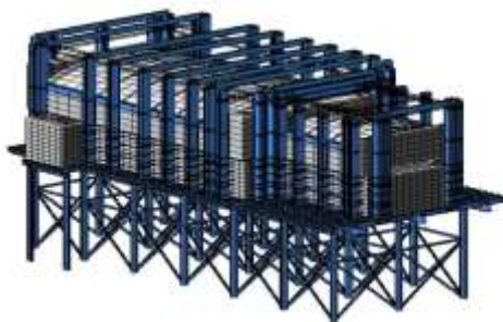
Рис. 1. Стекловаренная печь производительностью 100 т в сутки
