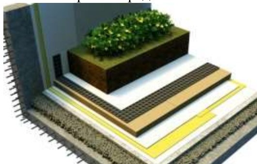
Рис. 1 Конструкция слоев «зеленой» кровли
