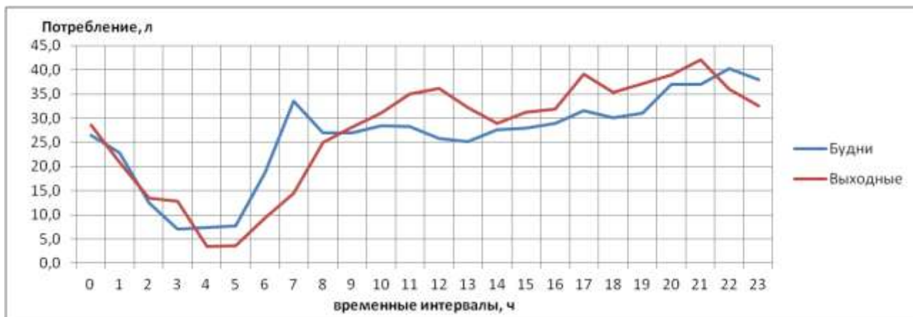
Рис. 5 Режимы потребления горячей воды квартирами в будни и выходные в течение суток, л
