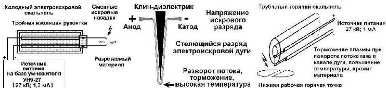
Рис.1 Два вида режущего электроискрового инструмента
