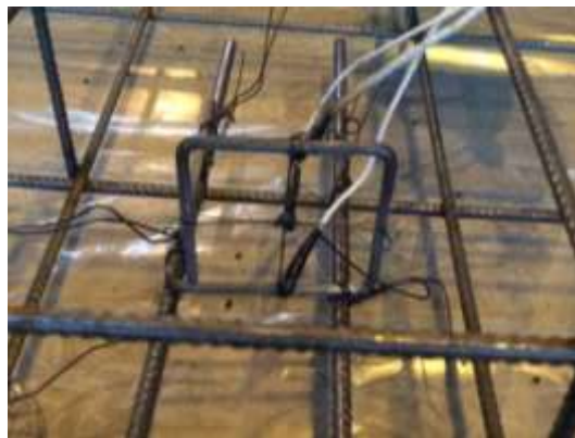
Рис. 3. Рамка-держатель с установленными термопреобразователями
