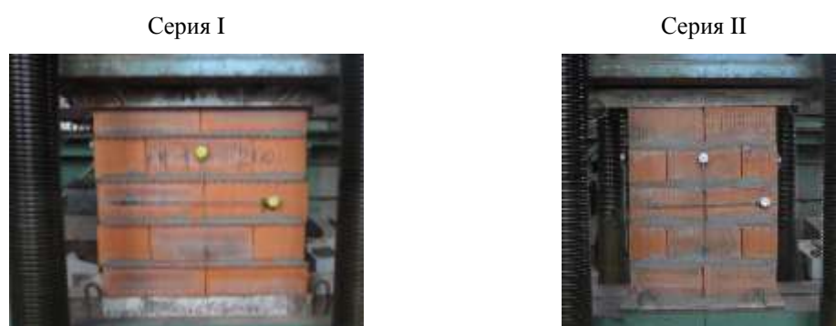
Рис. 3 Общий вид опытных образцов в прессе до начала испытаний
