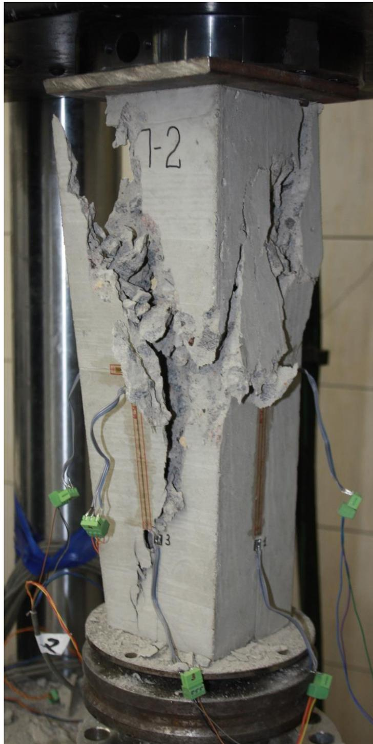
Рисунок 2.10 – Испытание образцов призм
