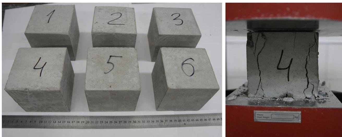
Рисунок 2.9 – Испытание бетонных кубов
