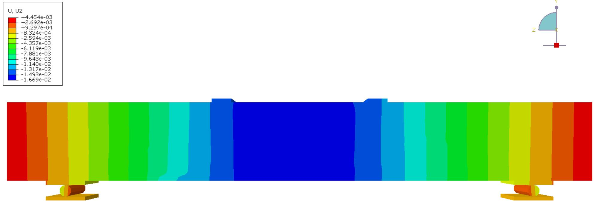
Рисунок А.1 – Изополя вертикальных перемещений в момент перед разрушением для образца ВО-I-01
