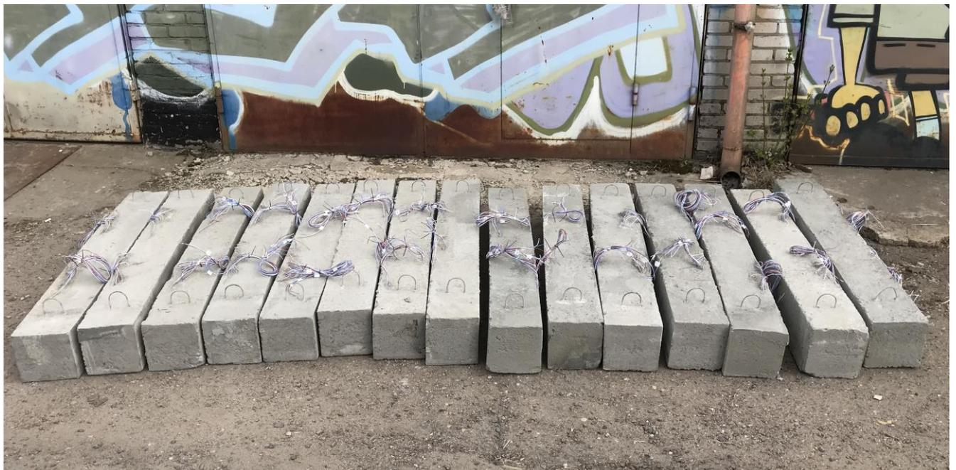
Рисунок 2.3 – Распалубка опытных образцов
