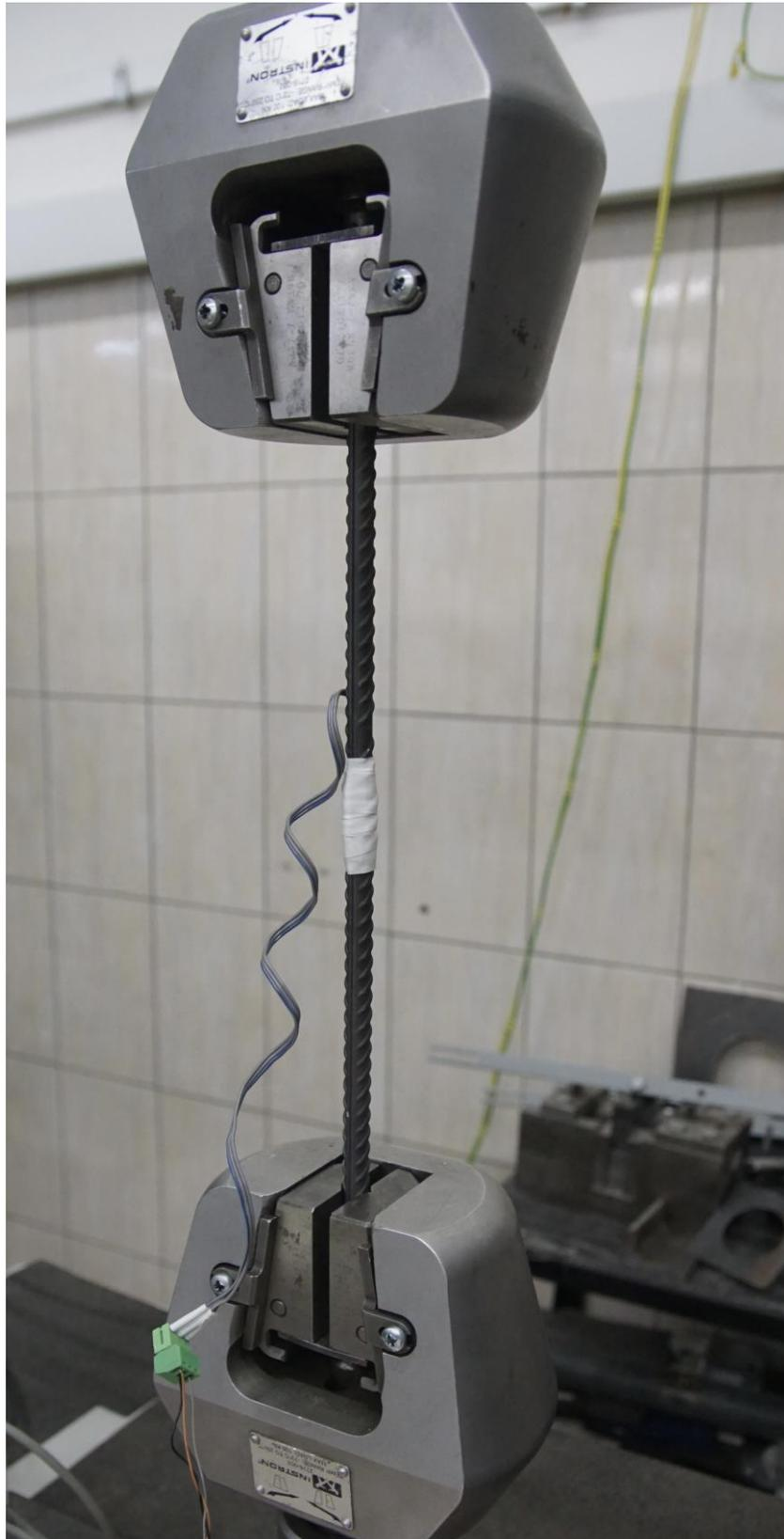
Рисунок 2.15 – Испытание арматуры класса А500
