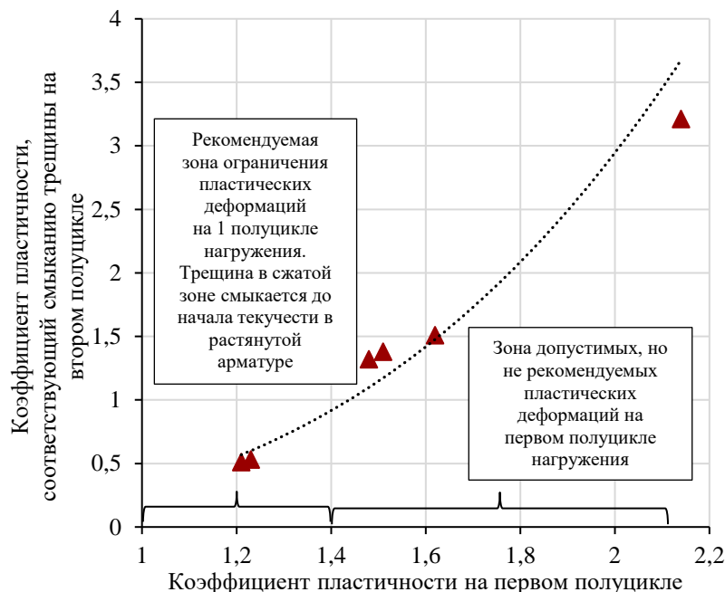
Рисунок 11 – Зависимость коэффициента пластичности, соответствующего смыканию трещины на втором полуцикле, от максимального коэффициента пластичности в первом полуцикле
