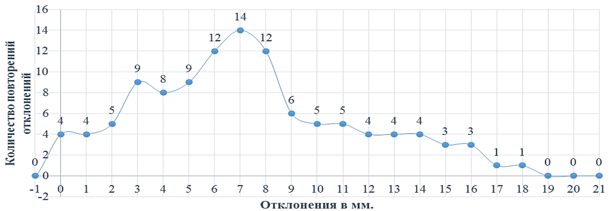
Рисунок 8 – График значений отклонений высоты бетонируемого яруса
