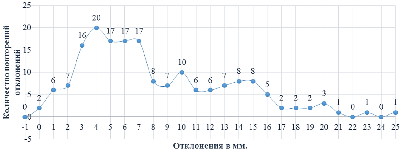
Рисунок 3 – График отклонений высоты бетонируемого яруса стен
