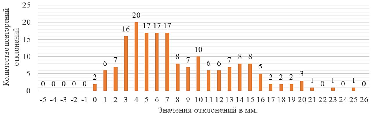
Рисунок 2.5 – Гистограмма значений отклонений высоты бетонизируемого яруса стен
