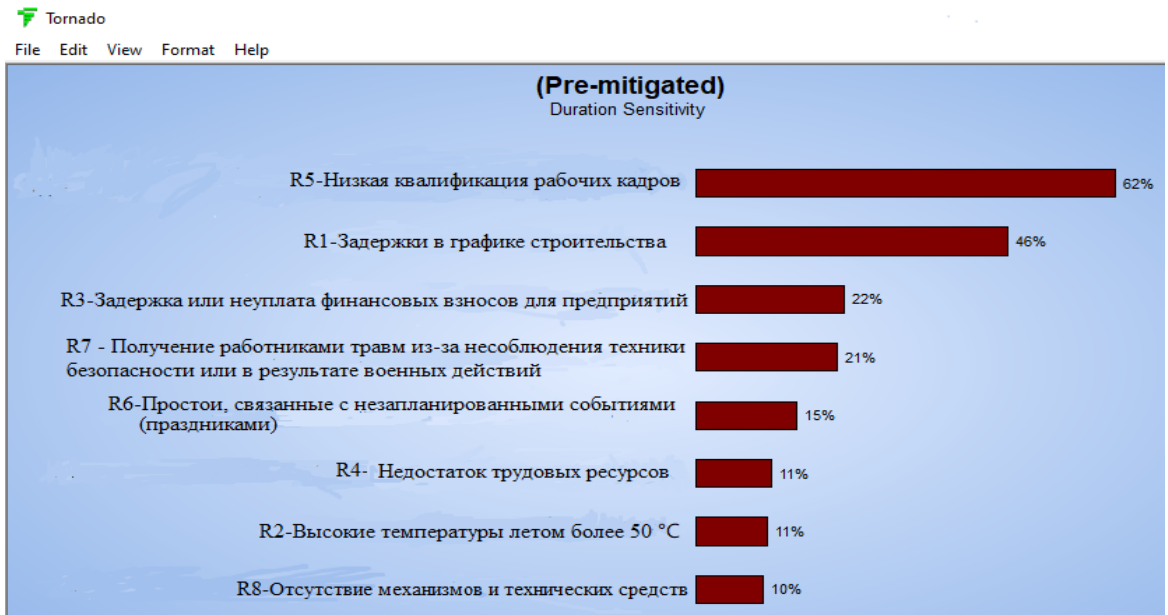
Рис. 4.13. График чувствительности торнадо
