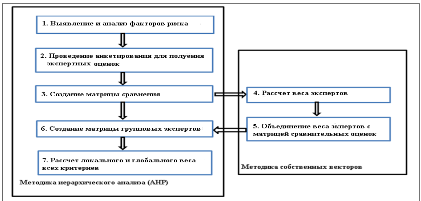
Рис. 3.3. Блок-схема процесса иерархического анализа[94,96]
