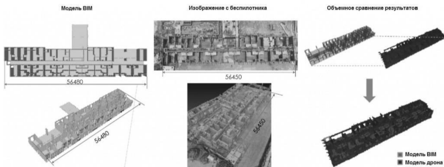
Рис. 2. Сравнение плана и графика строительства с BIM-моделью. [7]
