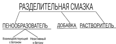
Рис. 2. Схема состав разделительной смазки
