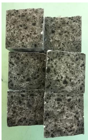
Рис. 1 Испытание на коррозионную стойкость пеностеклянного заполнителя при воздействии \text{NaOH}
