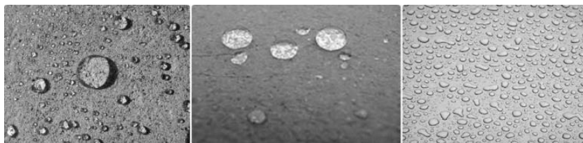
Рис.1 Поверхности, покрытые защитными составами
