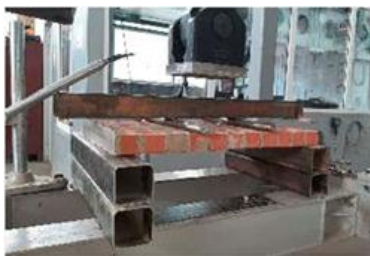
Рисунок 2. Момент испытания опытного образца на изгиб
