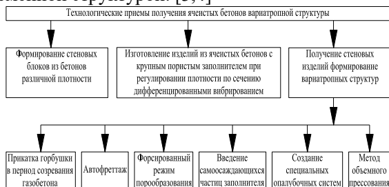
Рис.1. Существующие способы производства структурно-переменных ячеистых бетонов
