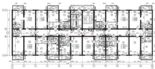
Рис. 1. План типового этажа 12-этажного жилого дома
