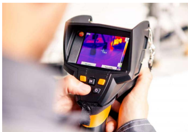
Рис. 2. Тепловизионное обследование конструкций зданий тепловизором Testo 875-1i
