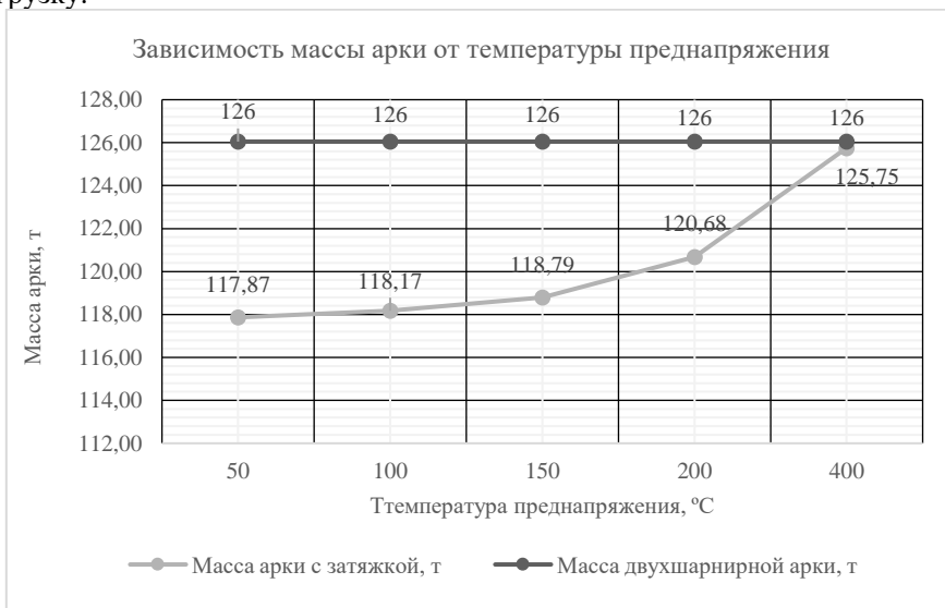
Рис. 2. Зависимость массы арки от величины предварительного напряжения затяжки.
