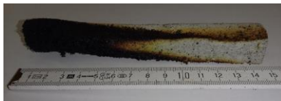
Рис. 2. Образец ППУ модифицированный терморасширяющимся графитом с концентрацией 10% масс. частей
