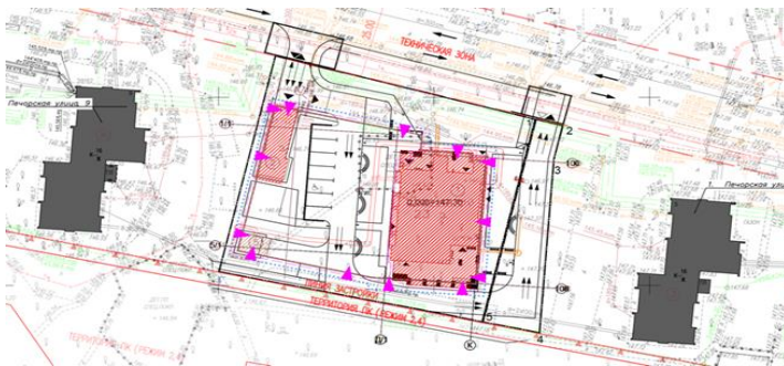
Рис. 1. Пример расположения деформационных марок на ограждающих конструкциях
