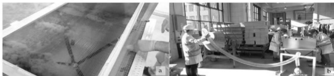
Рис. 2. Оборудование для очистки волокон: а) струны, возбуждаемые вручную; б) волокна, интегрируемые в бетонную смесь
