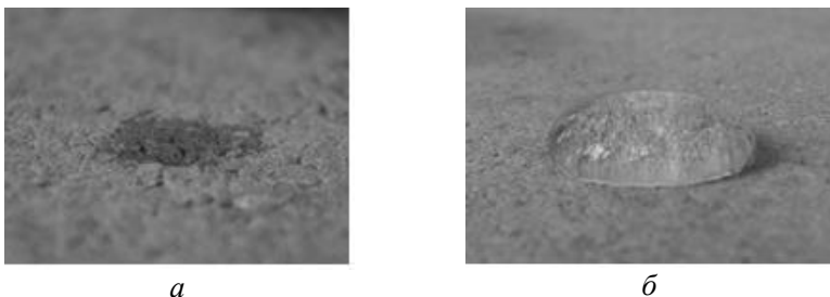
Рис. 2. Образцы строительного композита на основе гипсового вяжущего: а) до обработки гидрофобизатором б) после обработки гидрофобизатором.
