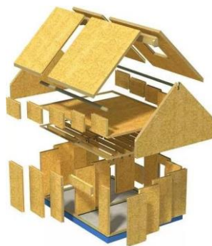
Рис. 2. Схема канадской технологии.
