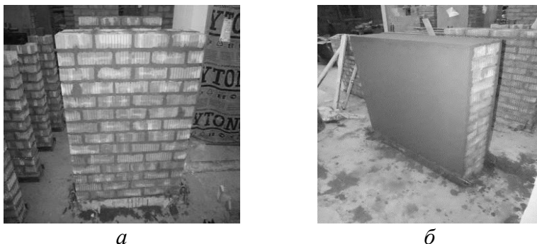
Рис.1. Общий вид эталонных и оштукатуренных образцов
