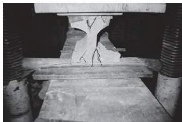
Рис.1. Разрушение стыка в опытах Соколова Б.С., Никитина Г.П.
