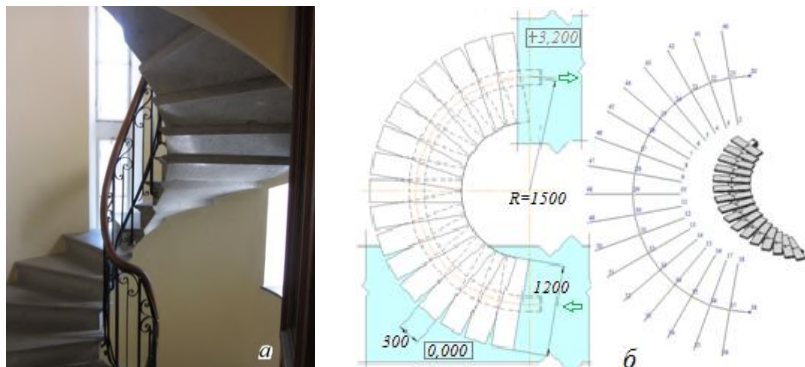
Рис.2. Общий вид висячей винтовой лестницы в здании старой постройки (а) и пример построения расчетной схемы лестницы с криволинейным маршем: исходная геометрия, расчетная схема, 3-D графика расчетной модели (б)
