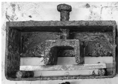
Рисунок 1. Образец в оснастке после выдержки в КСТ.
