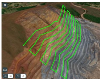
Рис.1 Исследование нарушенной территории, карьера с помощью БПЛА в программе ArcGIS Pro с SiteScan. Зеленым- обозначено заложенное в программу летное задание для БПЛА, с учетом высотных аспектов исследуемой территории.
