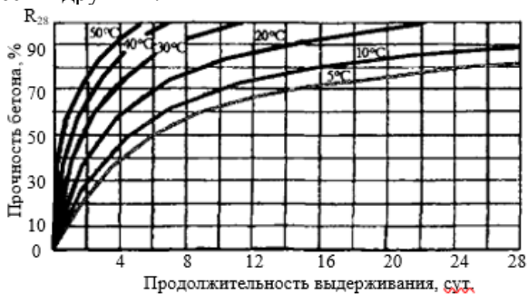
Рисунок 1. Зависимость прочности от температуры твердения бетона
