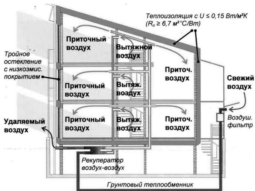
Рис. 1. Схема устройства пассивного дома
