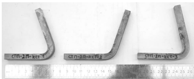
Рисунок 3. Определение угла загиба образцов.
