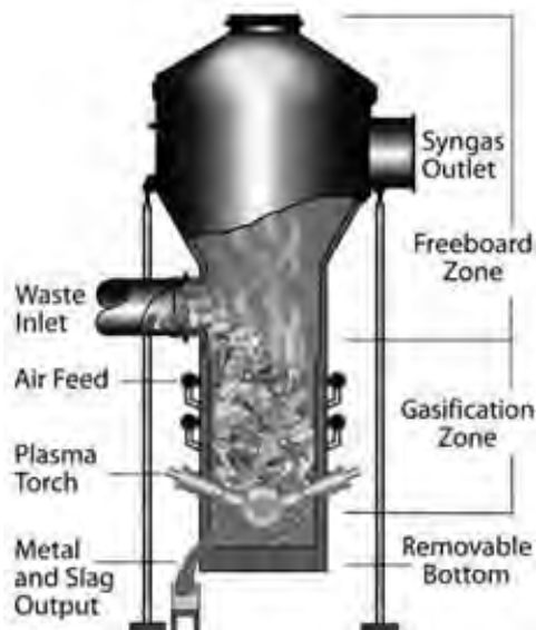
Рис.5. Общая концептуальная схема системы газификации в плазменной дуге [3]
