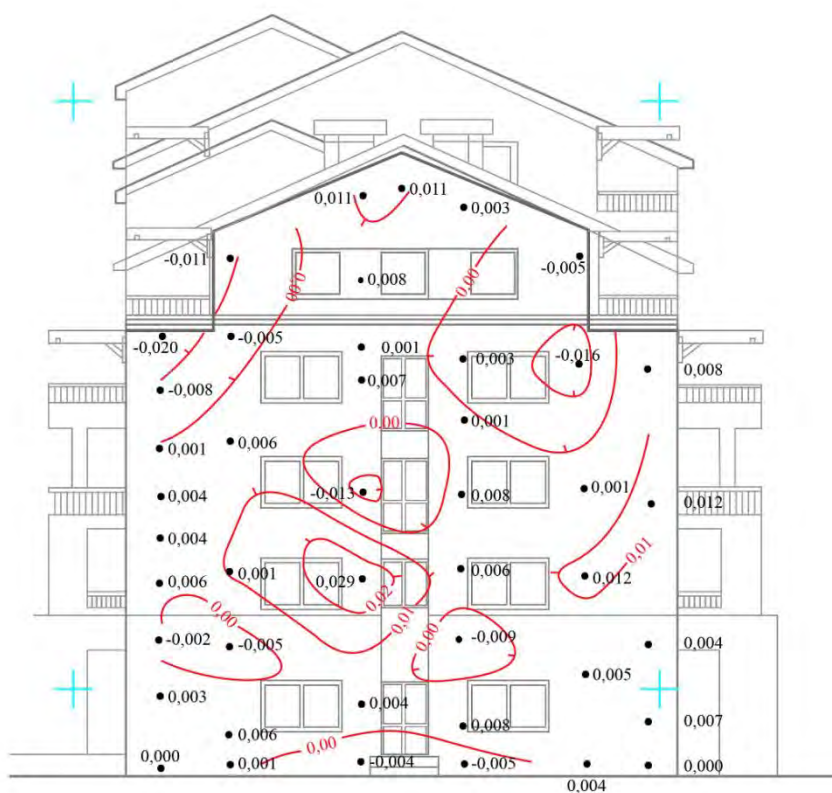
Рис. 2. Изолинии торцевой стены четырехэтажного здания с надстройкой
