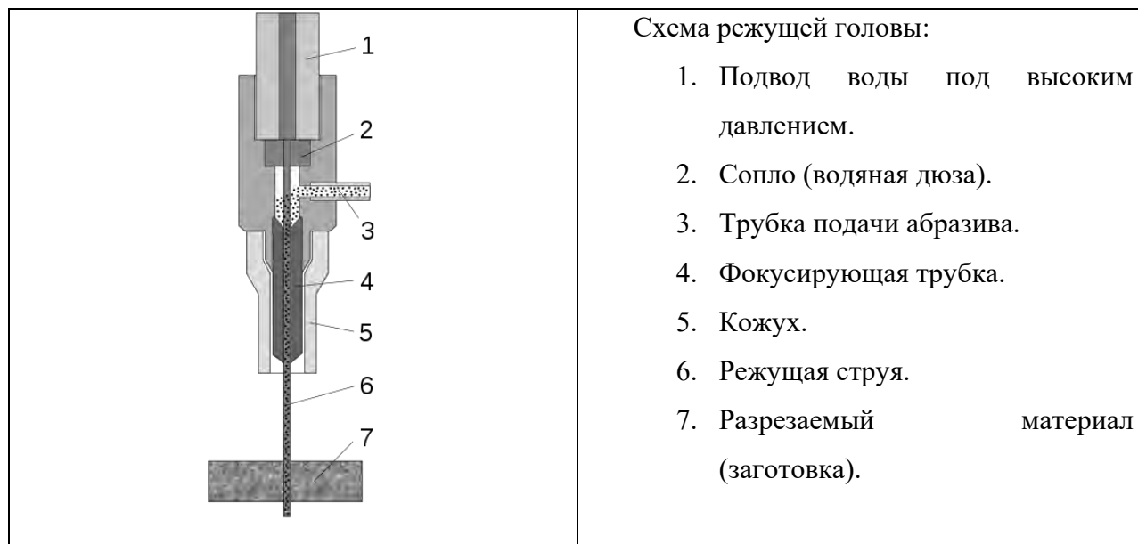
Рис.1. Схема режущей части гидроабразивного станка
