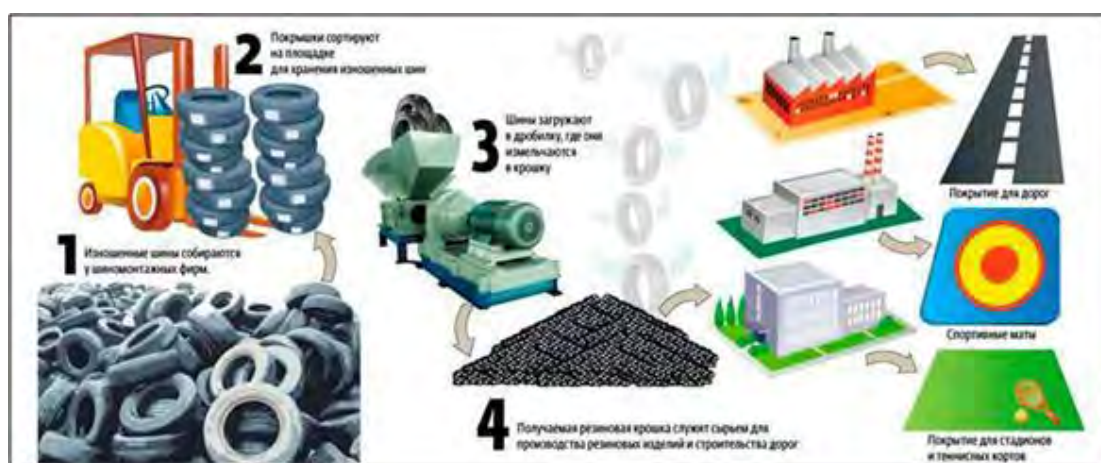
Рис.7. Физический метод переработки (дробление) [16]
