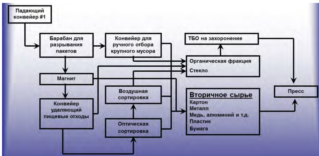
Рис. 5. Один из возможных составов мусоросортировочного комплекса [10]
