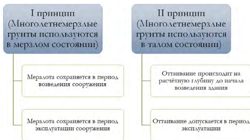
Рис. 2. Принципы строительства на многолетнемерзлых грунтах
