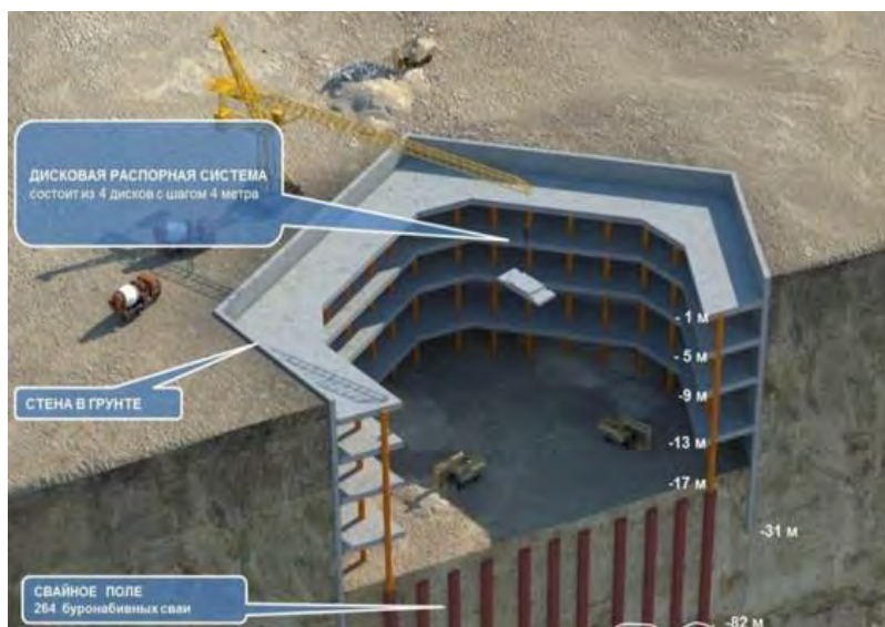
Рис. 3. Схема разреза и вид «стены в грунте»
