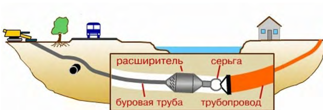
Рис.1. Схема прокладки трубопроводов методом ГНБ
