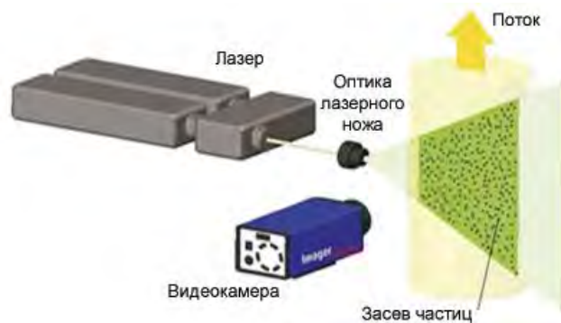
Рис. 2. Принципиальная схема работы измерительного комплекса лазерной трассерной визуализации.
