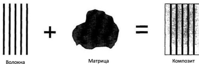
Рис 2. Структура композита, армированного волокнами
