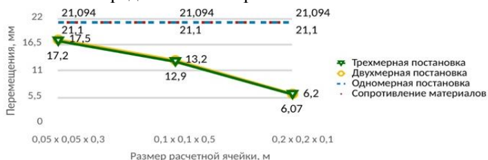
Рис. 6. Результаты сеточной сходимости задачи об изгибе балки
