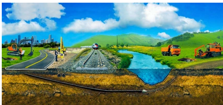
Рис. 4. Производство строительных работ по устройству трубопровода методом ГНБ
