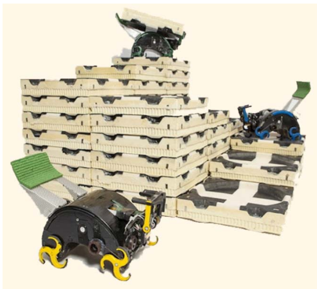
Рис. 4. Дроны «TERMES» (роевое строительство)
